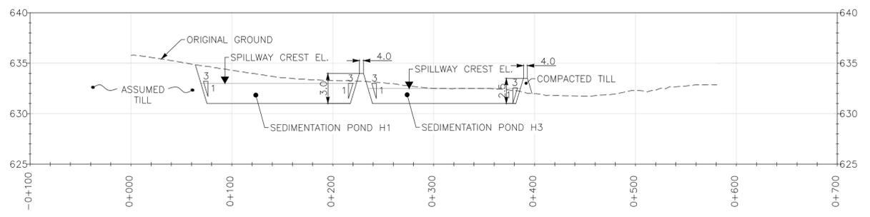
**LONGITUDINAL PROFILE - SEDIMENTATION POND H1, H3**
