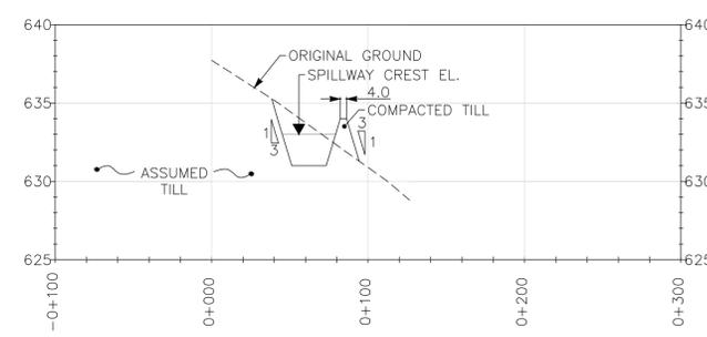
**SECTION A-A - SEDIMENTATION POND H1**
