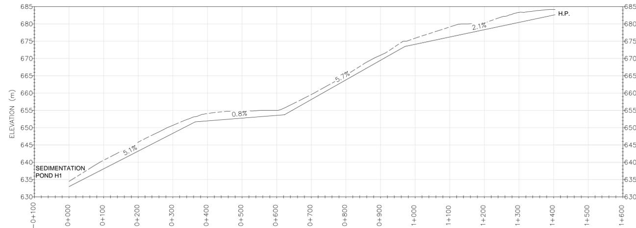
LONGITUDINAL PROFILE - DITCH DD-1
