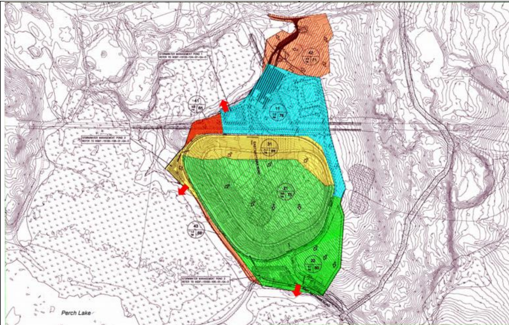
Figure 3 : Zones de déversement des BGES (flèches rouges) et zones de captage post-fermeture
