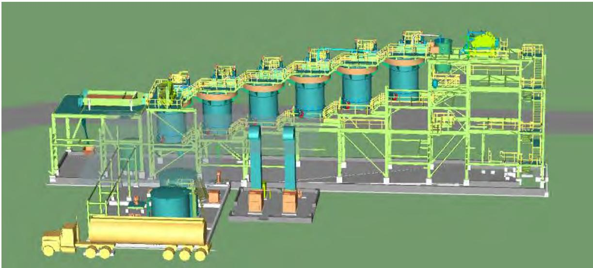
Figure 2-4 Circuit du charbon en colonnes (CIC)
