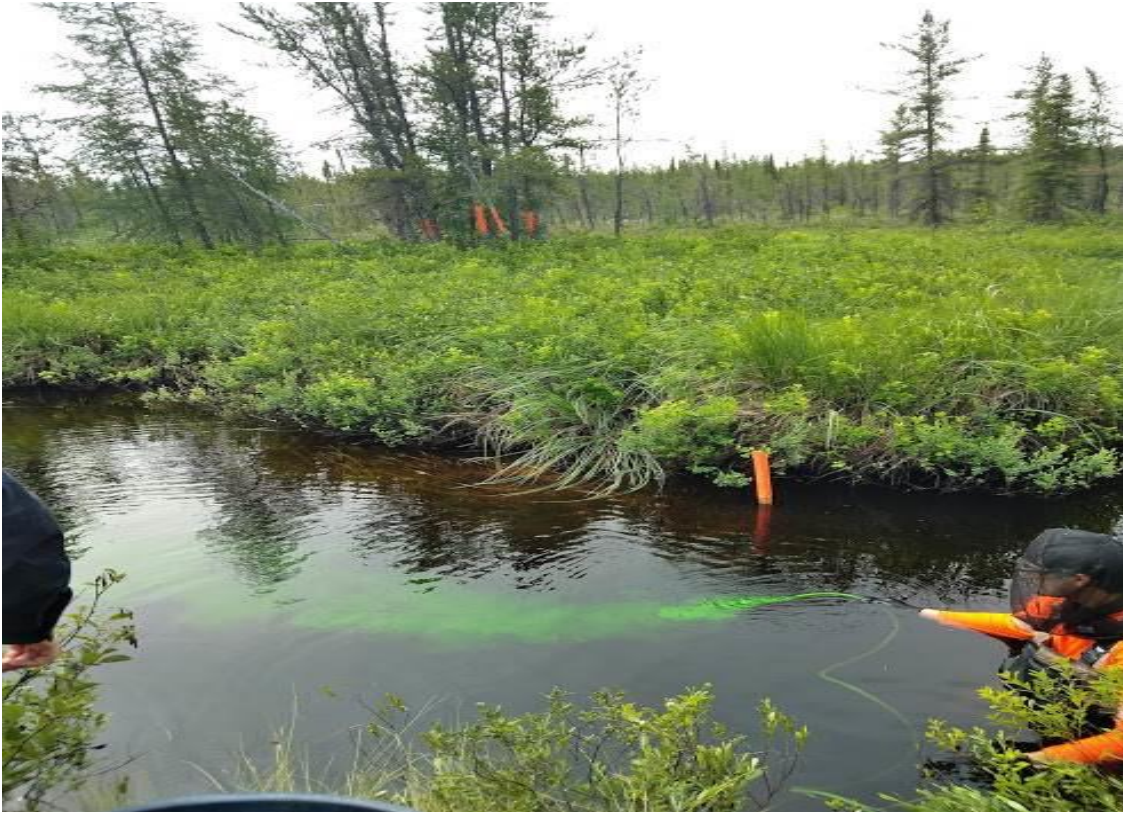
Photo 2-3 Essai de débit à la station hydrologique HY2
