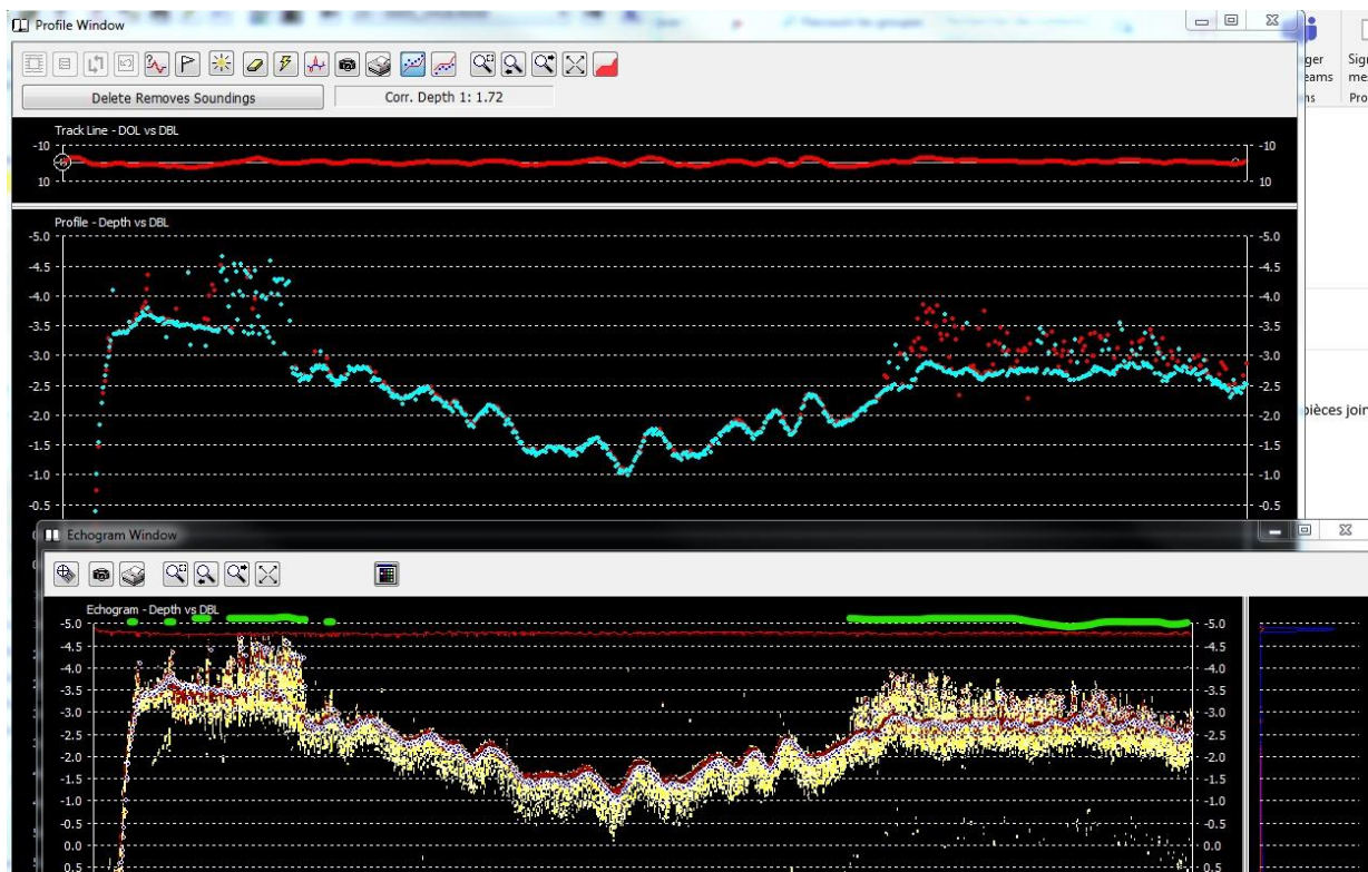
Figure 1 Exemple de délimitation d'herbier par HYPACK. Données bathymétriques en haut, échogramme en bas. La ligne verte indique les endroits avec présence de plantes aquatiques
