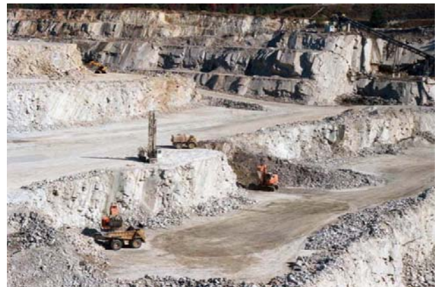
Fig. 2-1 Banquettes créées en cours d'exploitation et matériel type utilisé dans les grandes carrières.
